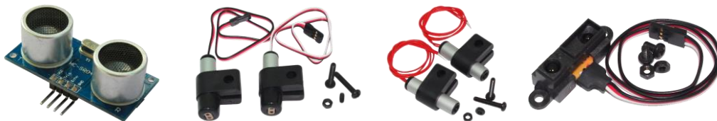
Slika 3 - Ultra zvočni, IR, foto senzori in senzor razdalje
