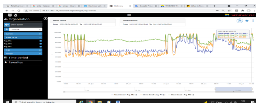
Slika 10: Prikaz časovnih vrednosti tokov in moči, konic na posameznih faznih vodnikih ŠC Kranj na treh različnih faznih dovodih (moder, zelen in oranžen porabnik) (Vir Sitar, 2021, stran 36)
