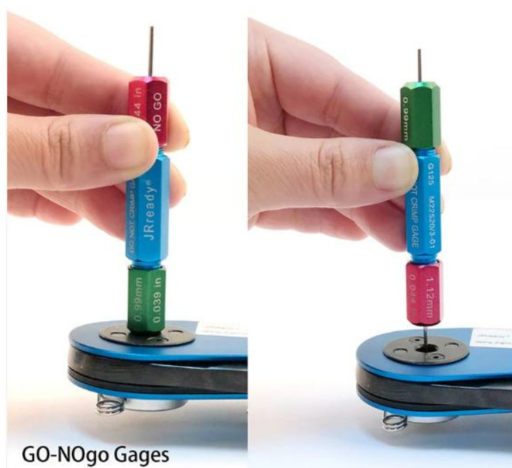
Slika 4: Princip delovanja kontrolnika GO-NOGo
